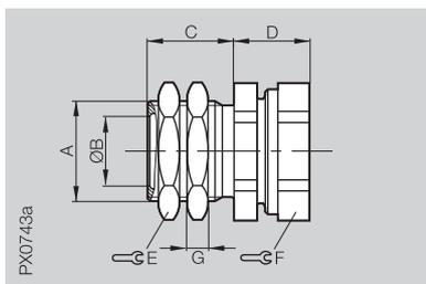
**Dispositifs de serrage à butée fixe pour les têtes de lecture/écriture avec une longueur de filet de  $\geq 30$  mm (matériau : CuZn, nickelé)**
