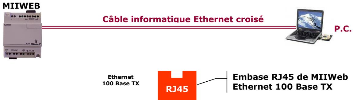
Lorsque MIIWeb est connecté, la LED de trafic réseau clignote au gré des transactions de paquets TCP/IP entre le PC et le WebServer.
