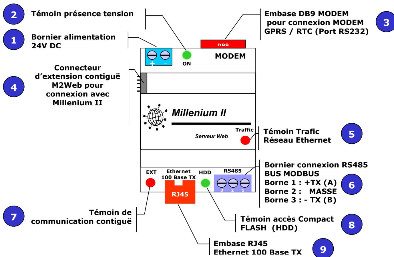
**1 : Bornier d'alimentation 24 V DC :** L'alimentation doit délivrer une tension de 12 V à 30 V DC pour un courant crête de 400 mA.
