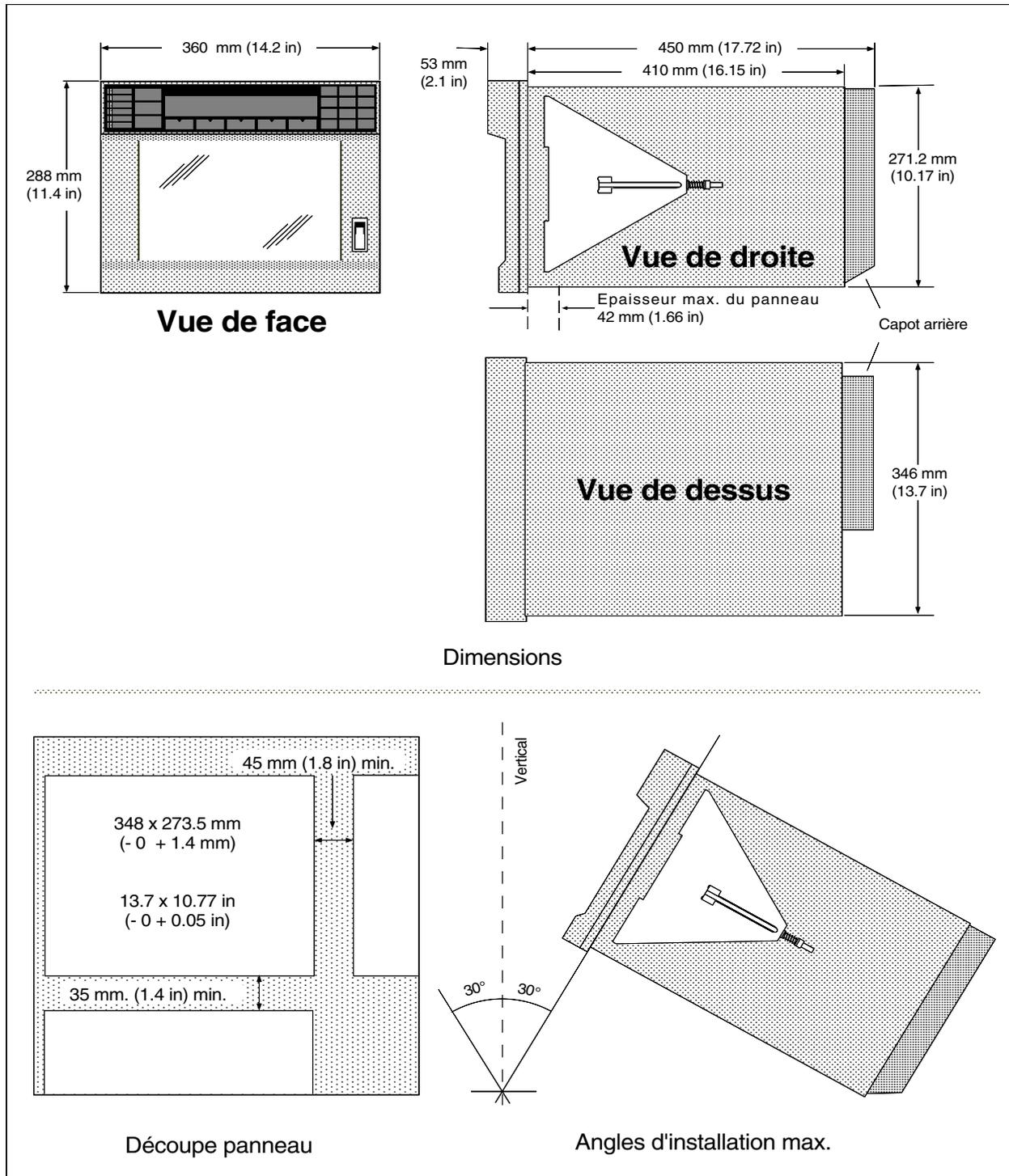
Figure 1.3 Installation mécanique
