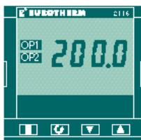
Le 2116 est un régulateur de température PID ou "Tout ou Rien", de format 48x48 mm. Il a une entrée configurable pour l'ensemble des thermocouples standard et sonde à résistance, signaux mV ou mA. Il propose en standard 2 sorties : une sortie logique pour piloter un contacteur statique et une sortie relais qui peut être configurée en sortie régulation chauffage ou refroidissement ou bien en alarme.
