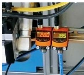
Des valeurs peuvent être programmées pour changer la couleur en fonction de l'état de la sortie de commutation (par ex. rouge : sortie 1 commutée ; vert : sortie 1 non commutée).
