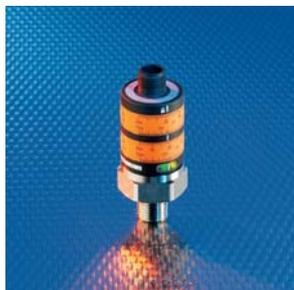
Les capteurs de pression PK ont des anneaux de réglage mécaniques rotatifs pour régler rapidement les points de consigne haut et bas de l'application. Le capteur est réglable sans pression du système et tension d'alimentation. Ainsi un manomètre séparé n'est plus nécessaire. Le boîtier compact est idéal pour un montage dans un espace exigu.
