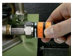
Les points de consigne haut et bas sont réglés grâce aux anneaux mécaniques du capteur PK.
