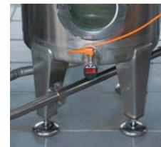
Surveillance du niveau de liquides dans une cuve à l'aide de capteurs de pression PN.
