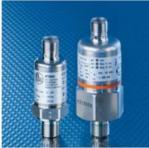
Les transmetteurs de pression PT et PA sont robustes et une solution fiable pour le contrôle de pression dans des applications hydrauliques et pneumatiques. Les options de sortie peuvent être 4...20 mA ou 0...10 V. Les transmetteurs possèdent une membrane en céramique (série PA) ou en inox (série PT), résistantes aux fluides agressifs (gaz ou liquides).
