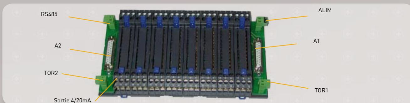
Les convertisseurs **GK3000D1** sont plugués sur la platine PLTB08AD, chaque sortie vers l'actionneur est indépendante et isolée.
