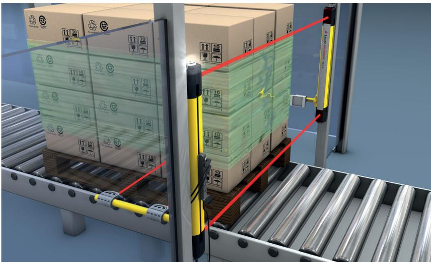
*Grâce à la fonctionnalité d'inhibition, les palettes peuvent passer à travers un équipement de protection électro-sensible sans interrompre le processus aussi bien avec le moniteur de sécurité ASM1E qu'avec le moniteur de sécurité ASM2E.*
