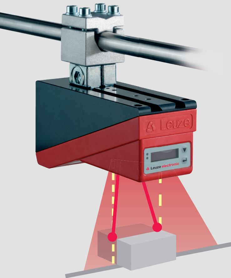
Les capteurs LES mesurent la taille des objets par rapport à leurs arêtes. Le capteur calcule et délivre les positions exactes des objets grâce aux décalages en hauteur.
