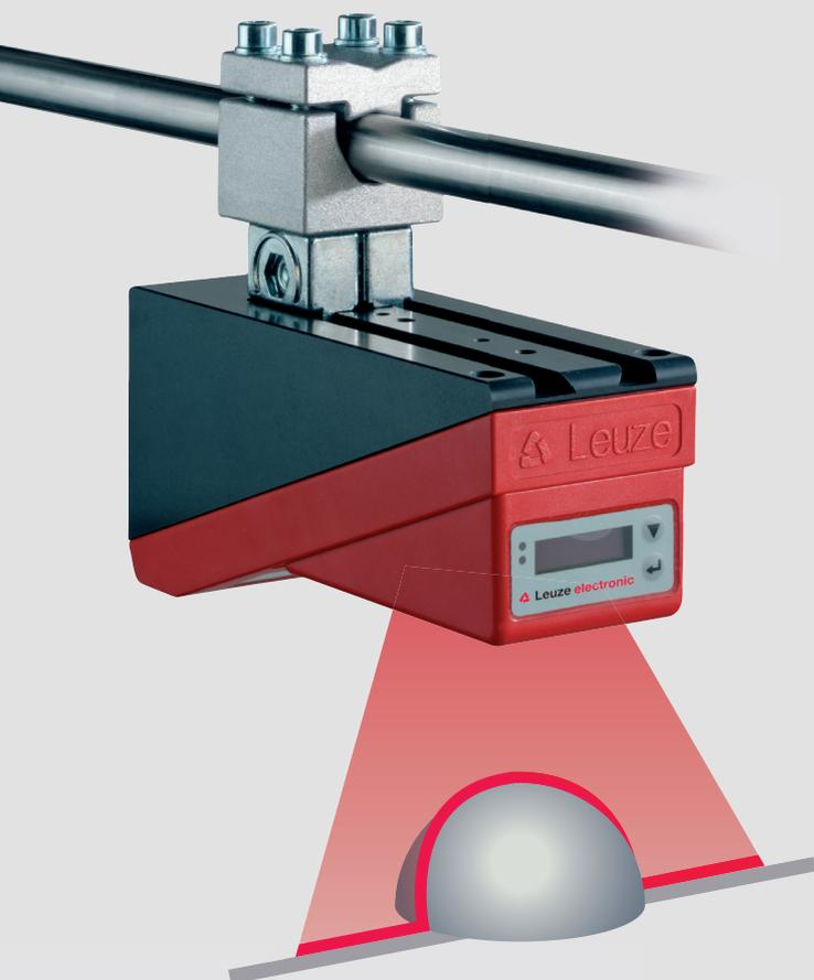
Le capteur LPS s'utilise partout où les dimensions ou la position d'un objet doivent être mesurées, que celui-ci soit mobile ou statique. Le raccordement d'un encodeur permet de générer des données 3D lors du balayage d'objets mobiles. Il en résulte de nombreuses possibilités d'utilisations pour la mesure, de contour et de volume.
