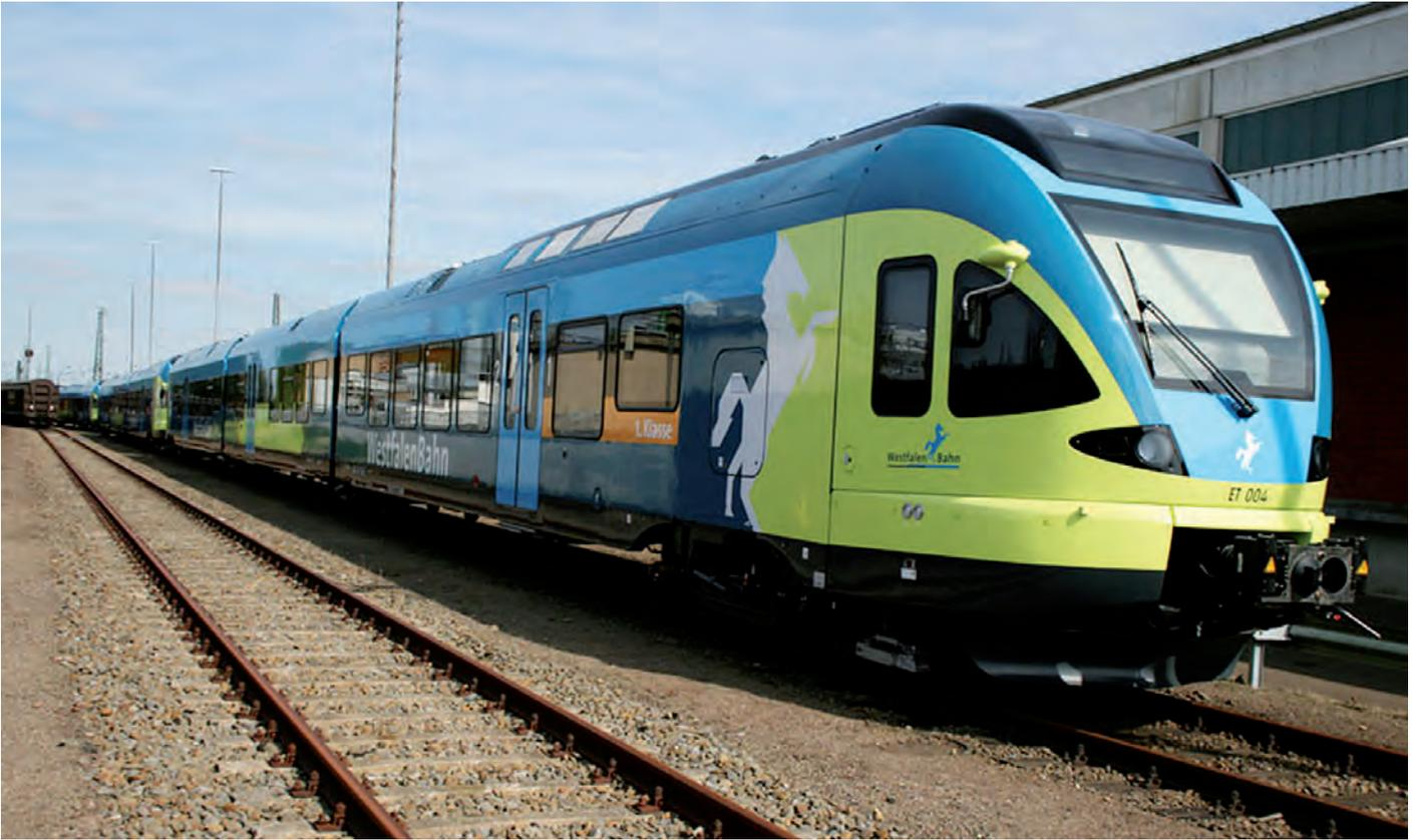
Le FLIRT (Fast Light Innovative Regional Train) est un véhicule à plancher bas, réalisé selon le principe d'unités multiples. Il est développé et construit par Stadler Rail Group en tant que train régional ou commuter. En plus des produits de type contrôle commande et interface utilisés pour ce véhicule, Stadler s'est appuyé sur le savoir-faire de LÜTZE dans le domaine de la signalisation. Ainsi des modules d'éclairage et des générateurs de sons font partie intégrante du FLIRT.
