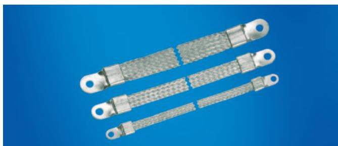
Bande de mise à la terre, tresse en cuivre étamé, disponible en différentes longueurs et sections avec des cosses de contact serties. Les bandes de mise à la terre agissent contre l'effet de peau en présence de fréquences élevées, tout en offrant des possibilités de raccordement extrêmement flexibles.
