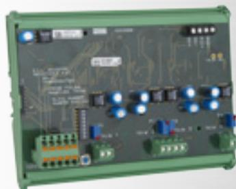
Module adressable de 4 sorties analogiques (recopie signal capteur, min, max, moyenne d'un groupe de détecteurs) pour raccordement sur un enregistreur, un automate, une GTB, etc.
