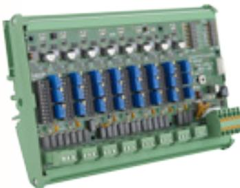
Module adressable de 8 entrées analogiques pouvant recevoir tous types de transmetteurs à sortie 4-20 mA (détecteurs gaz, flammes, température, etc.).
