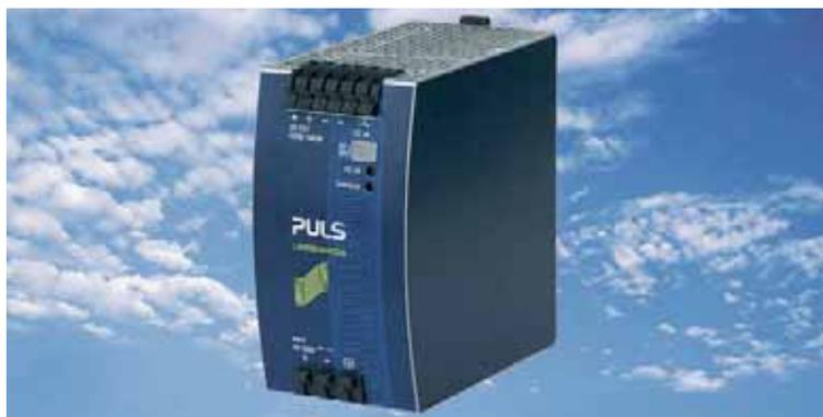
Les circuits intermédiaires sont souvent mal filtrés et génèrent d'importants courants parasites et de fuite. L'alimentation QTD20 est protégée contre ces phénomènes; elle dispose de filtres adéquats et d'un étage d'entrée renforcé. Elle est aussi munie des fusibles nécessaires pour 600Vdc et elle a reçu l'homologation UL et CEI.
