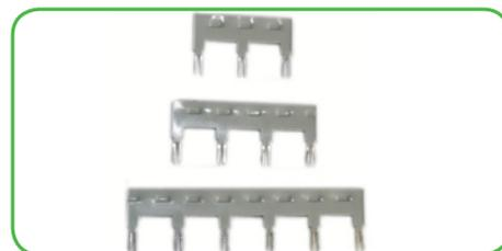
Les peignes de pontage existent en 2, 3, 4, 6 et 8 broches. Cela permet de shunter des communs du côté des contacts.
