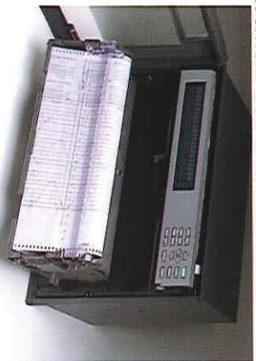
Le ruban encreur se présente sous la forme d'une cassette facilement remplaçable. De même, le logement du diagramme peut être retiré facilement. Le ruban encreur et le diagramme sont ceux déjà utilisés pour le modèle HR2400.
